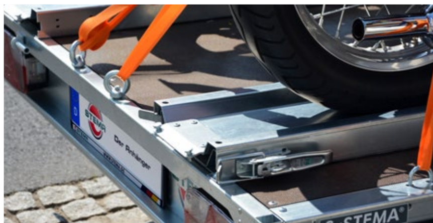
STLP 850 verfügt über 4 zusätzliche versenkbare Verzurrbügel
