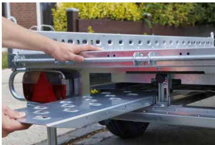
Integriertes Fach für Auffahrschienen
