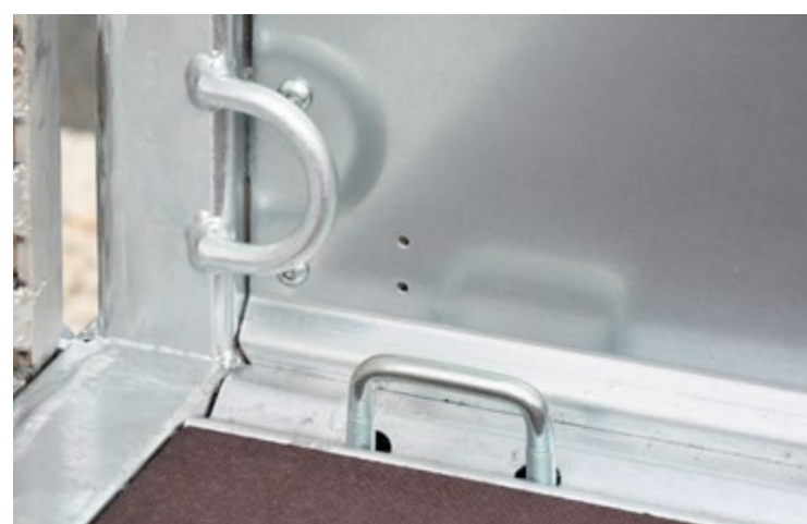
versenkbare Verzurrbügel und verschweißte Zurrösen
