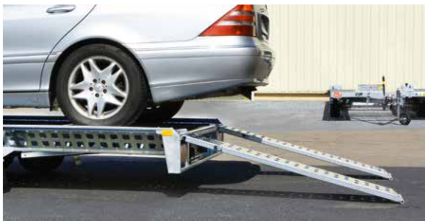
Auffahrschienen behalten auch beim Kippvorgang den Bodenkontakt
