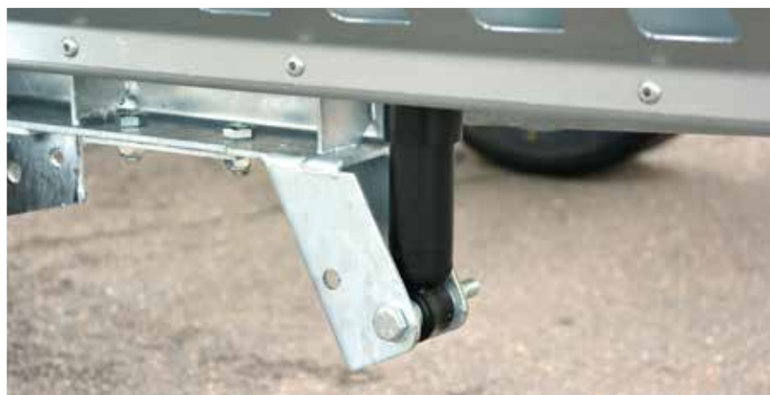
wartungsfreie hydraulische Stoßdämpfer bringen Kippbrücke in Schräglage
